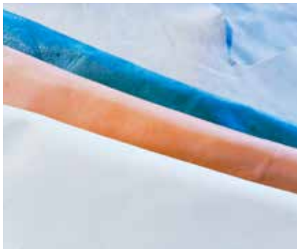
应用齐鲁工业大学研发的无铬鞣剂及其技术生产的无铬鞣皮革
