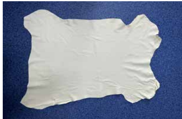
应用陕西科技大学科锐新材料研究所研发的无铬鞣剂KRT-S及其技术鞣制的羊皮服装革
