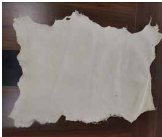
应用中国皮革制鞋研究院研发的无铬鞣剂 NCT 及其技术鞣制的无铬鞣坯革
