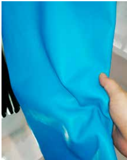
应用“斯塔尔”产品及技术生产的无铬鞣牛皮汽车革
