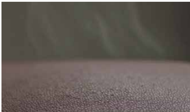
图5 具有良好透气性能的咖啡渣合成材料
