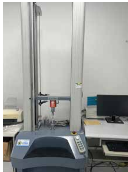
图5 伺服控制电脑系统拉力试验机
