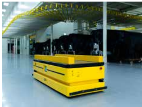
车间实现自动挂晾和 AGV 智能搬运
