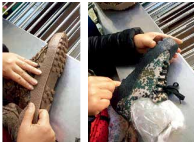
图 3 采用热硫化包头围条整体化工艺制作的作训鞋
