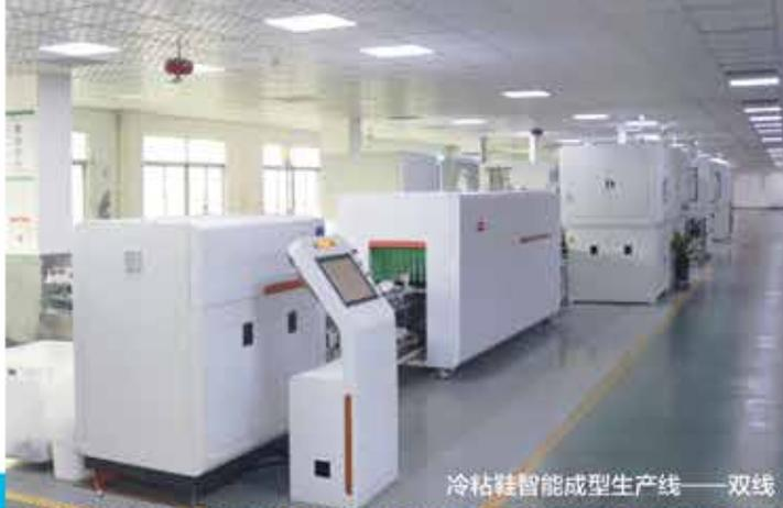
冷粘鞋智能成型生产线——双线
