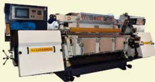
GJ2A9 系列剖层机 Splitting machine
